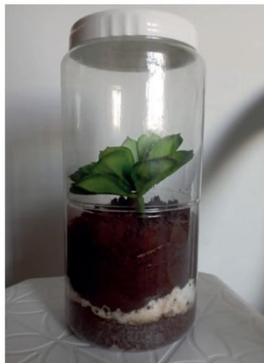
O protótipo inicial de um vaso contendo uma camada de hidrogel na terra, alguns centímetros abaixo da raiz da planta
