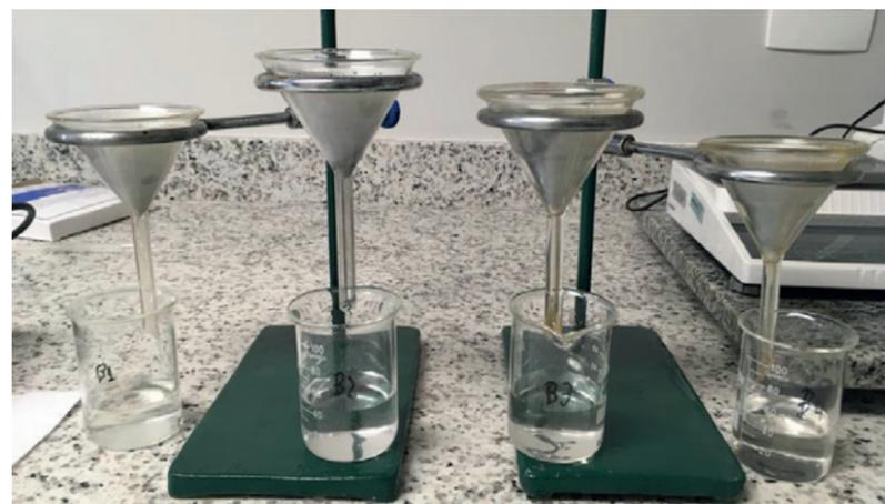
Para realizar a titulação complexométrica, Letícia utilizou quatro béqueres contendo 50 mL de solução de zinco e mais quatro com 50 mL de solução de cádmio e adicionou quantidades variadas de adsorventes a cada um deles
