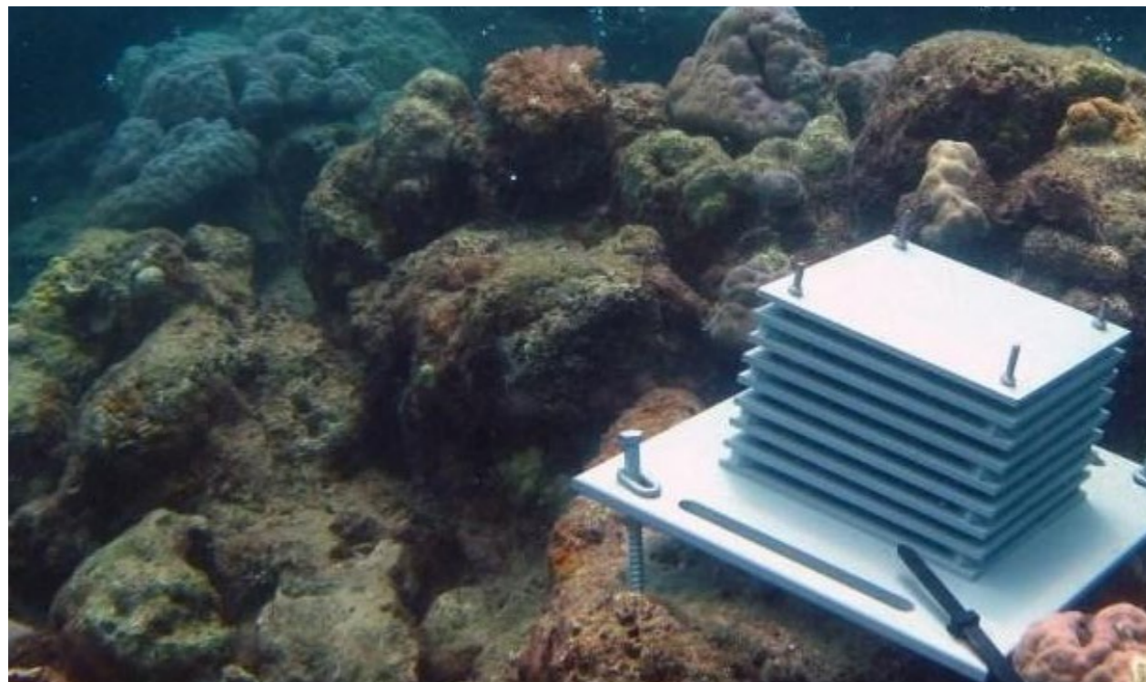
Exemplo de ARMS (estruturas autônomas de monitoramento de recife) instaladas em um coral
