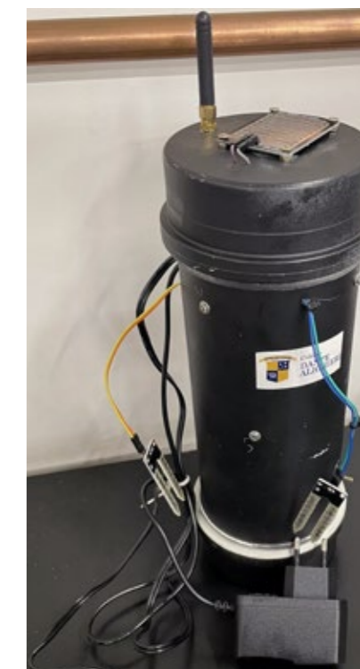
O protótipo foi desenvolvido com tecnologia Arduino para controle de sensores e automação
