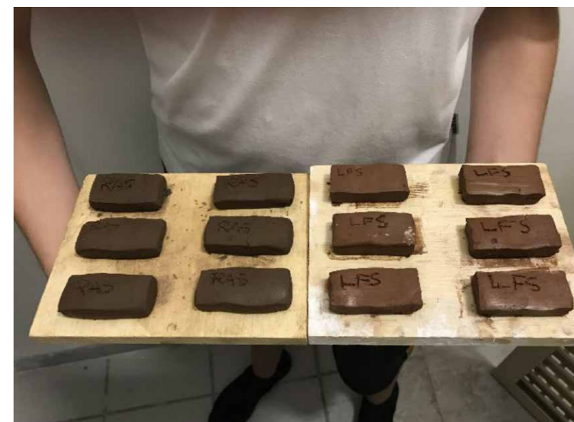
Minitijolos fabricados com resíduos da Samarco. À esquerda, resíduo arenoso (RAS), e à direita, lama de flotação (LFS)
