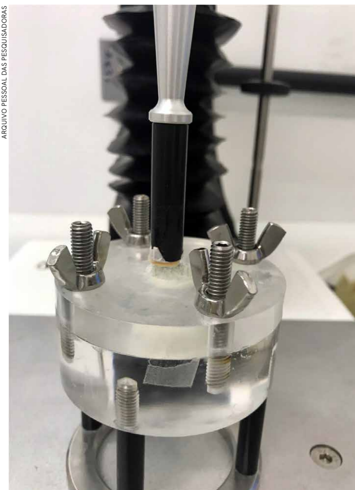
Texturômetro, aparelho usado para avaliar a mucoadesão do hidrogel
